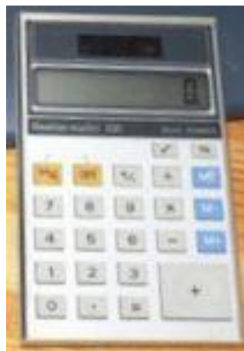
Nestler matho 220. Dit exemplaar heeft een klein zonnepaneel en een grote plus-toets.
