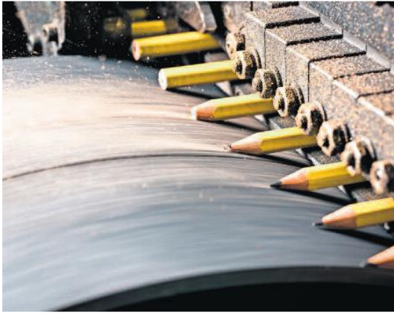
Fig. 9. Machinaal potloden slijpen in de fabriek.
