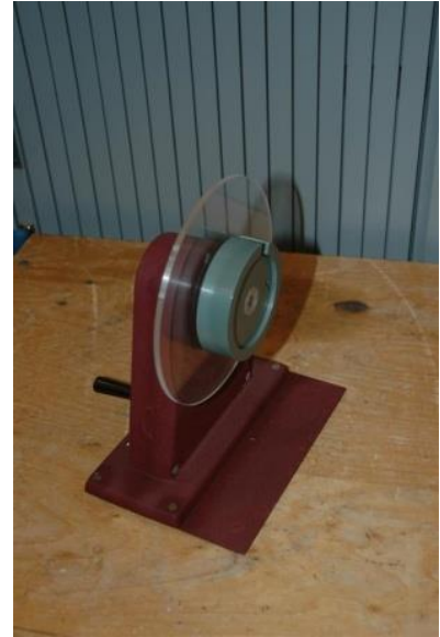
Fig. 11. Handgaten ponsapparaat voor het verbeteren (editen) van de band. Met behulp van dit apparaatje konden 'vergeten' gaten worden bijgemaakt of gecorrigeerd.
