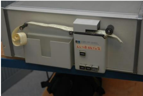
Fig. 9. De HP 2748B Paper Tape Reader voor opgerolde ponsband. Deze optische lezer leest 300 karakters (bytes) per seconde.
