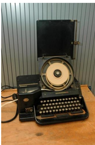
Fig. 12a, links en fig. 12b, rechts: Lorenz HL-38 5-gaten per kolom ponsband typemachine.
