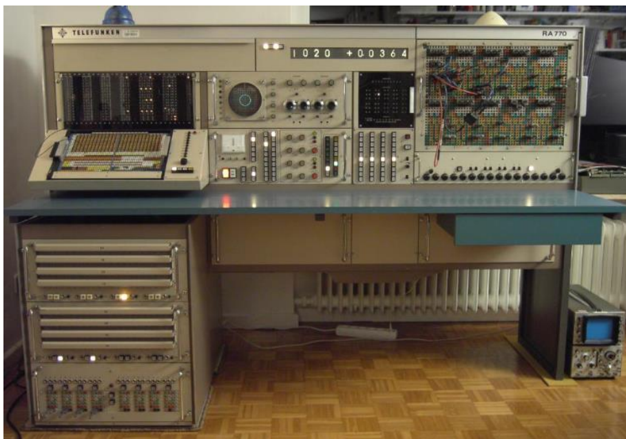
Fig. 1. Een fraai geres- taureerde Telefunken RA770, een analoge computer uit 1966. Foto van de website Ana- logmuseum.org, een website van Bernd Ul- mann. Zie [1].
