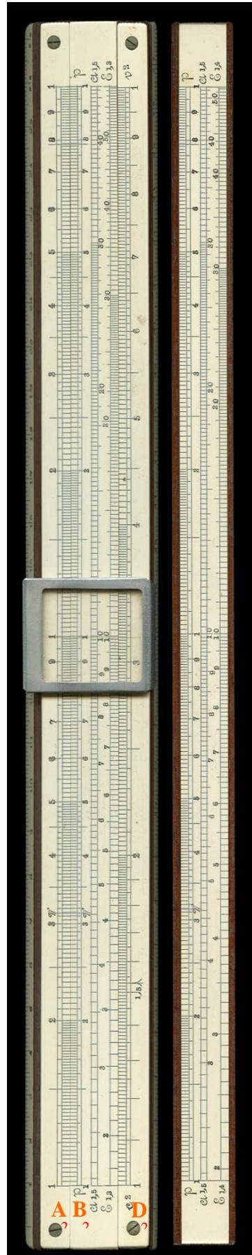
de oplossing ook: type 10038 – *Panzerformel-Rechenstab* Spitta & Leutz, Berlin, 1941. Deze rekenliniaal werd gebruikt bij geschutsberekeningen om doorslag van verschillende soorten pantserplaten te bepalen; hierbij werden exponentiële formules gebruikt met de op de rekenliniaal gevonden exponenten 1,3 en 1,4 en 1,5.
