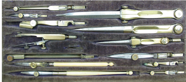
Figuur 2.1: Passerdoos van Riefler naar Zwitsers model, 220 x 100 mm
