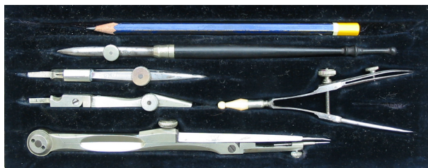
Figuur 1.3: Passerdoos van Gysi, 194 x 80 mm
