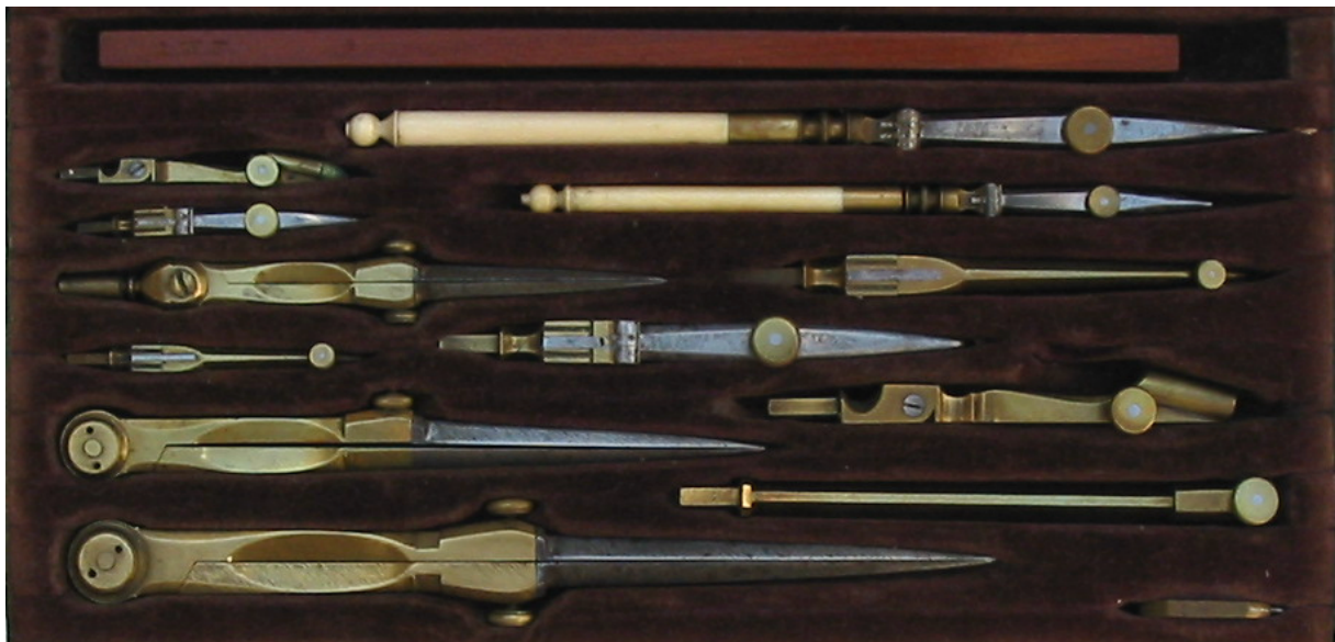
Figuur 1.4: Passerdoos van Kern, 215 x 110 mm
