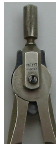
Figuur 4.3: Kopscharnier naar een Amerikaans patent uit 1903
