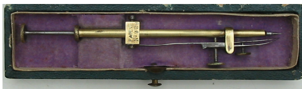
figuur 3.1: Eerste nulpasser, 120 x 30 mm
