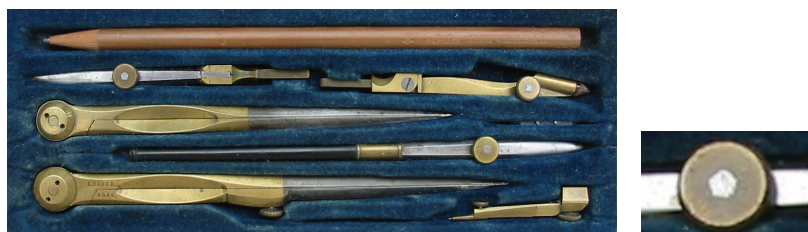
Figuur 1.1a: Passerdoos van Esser, 178 x 69 mm, en vijfkantige schroef-kartelschijf-verbinding
