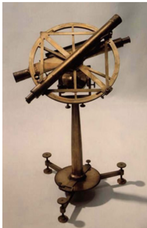
Figuur 6: een fraaie uitvoering van de Borda cirkel
