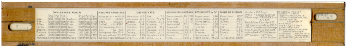
achterzijde met tabellen en gesloten vensters
